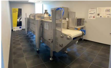
In-line microgolfoven van de Microwave Pilot waarop het pilootonderzoek zal uitgevoerd worden.
